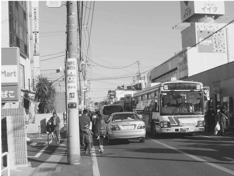
バスが通る幹線的な道路ですが、歩道がありません。路側帯に電柱が立っています。逆走する自転車が少なくありません。(撮影 杉田正明)
