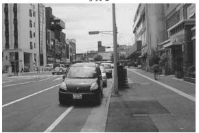
(写真1)鳥取市郊外。国道53号線沿い。路側帯はあるが、ブロックの内側が歩道兼、自転車道になっている。国道は交通量も多く、危険であるがゆえの配慮なのか、自転車もわずか1メートル足らずの中に押し込めた形になっている。
