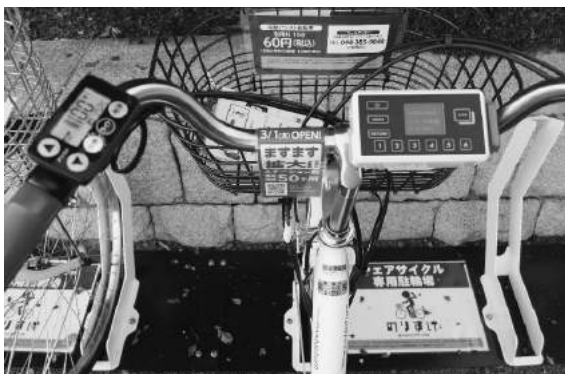
自転車のハンドル付近に搭載されている機器で、貸出・返却やICカードの登録などを行う。
