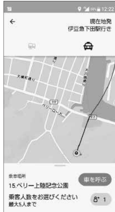
図12 スマートフォンの位置情報を使って現在地から最寄りの乗降所を割り出し、配車する
